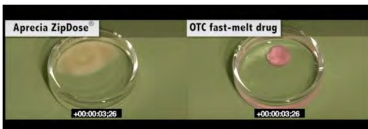
Figuur 2. De 3D-geprinte Spritam ® -tablet (links) dispergeert in enkele seconden, sneller dan een dispergeerbare tablet geproduceerd volgens 'fast-melt' technologie (rechts).
