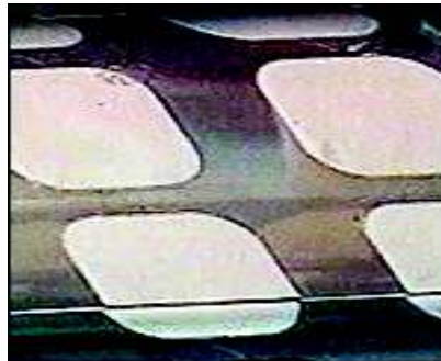
Figuur 7. Nieuwe toedieningsvormen vragen nieuwe productiewijzen: productie van transdermale systemen van het matrixtype. De pleisters zijn hier reeds gestanst en gereed om te verpakken.
